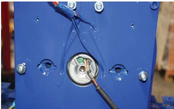
2. Retire el cable del Encoder del zócalo del terminal en el cuerpo.
