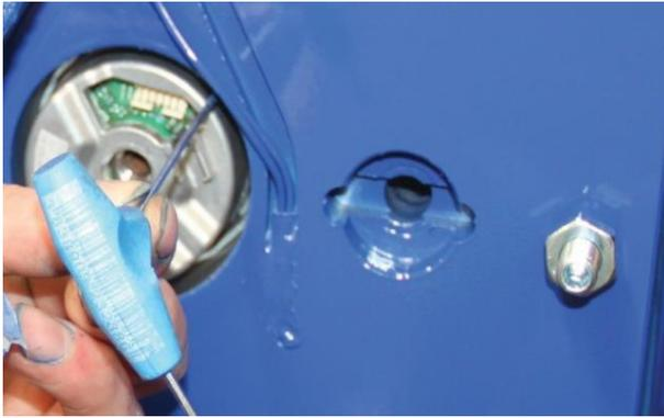
4. Afloje el perno de cabeza hexagonal en el anillo de retención de la carcasa del Encoder con una llave Allen adecuada
