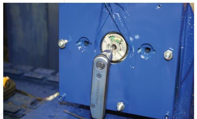
3. Retire el Encoder con una llave allen adecuada para el perno de cabeza hexagonal.
