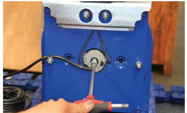
5. Retire el encoder del cuerpo de la máquina con la ayuda del perno M10.
